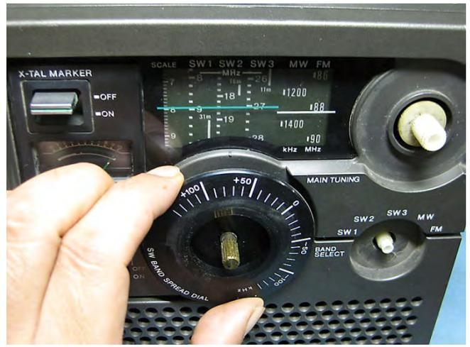
ダイヤルプレートを取り外します。まず、サブスプレッドダイヤルのシャフト付近に、プレートを固定しているスプリングを外します（左側写真では、このスプリングが欠落しています）。次にプレートを下方方向にズラしてから上方方向に引き上げると取り外せます。
