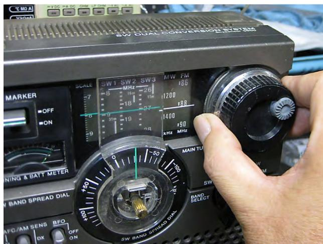
サブスプレッドダイヤルは、強く掴んで真上方向に引き上げると抜けます。固くてもドライバーでこじ開けないでください。ダイヤルパネルに傷が付きます。どうしても抜けない場合は、後で説明するように、ダイヤルシャフトにタコ糸を巻き付けて、真上にタコ糸を引っ張りながら、ダイヤルつまみを真上方向に引き上げます。
