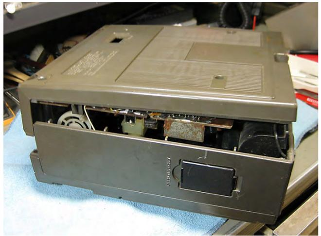
4本のネジを外したら、前と後ろで2枚のケースが外せます。電池蓋（写真左では欠落しています）を取り外し、前と後ろのケースをそっとこじ開けます。
