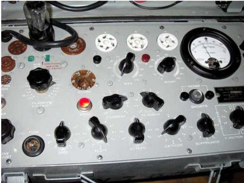
前回の診断で、OPT(出力トランス)の、1次コイル断線を確認しましたが、取りあえず、真空管を、試験機でチェックしましたところ、全員合格でした。
