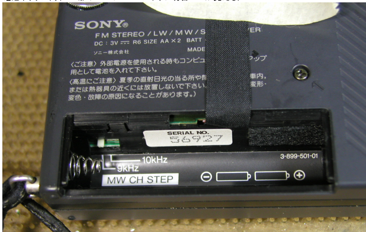
電池ボックス内(MW 帯の 9kHz/10kHz ステップ切替 SW が見える)
