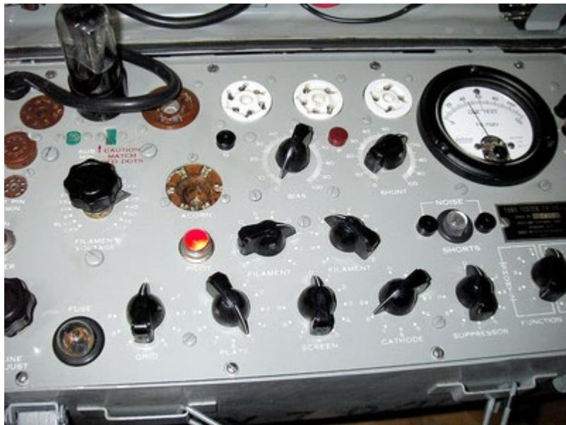
前回の診断で、OPT(出力トランジスト)の、1次コイル断線を確認しましたが、取りあえず、**真空管**を、**試験機**でチェックしましたところ、全員合格でした。
